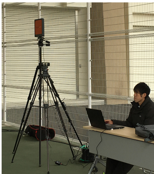
図 1(1) 打球測定の様子 (トラックマンによるデータ収集)
