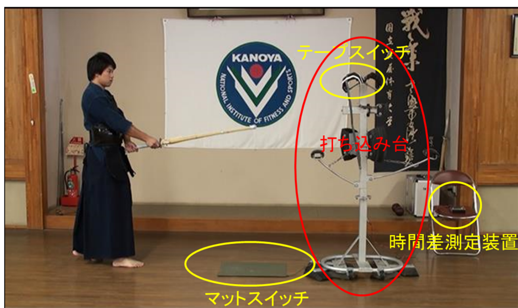
図1 測定機器の設置
