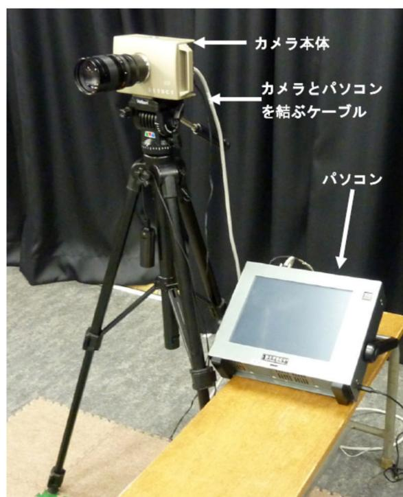
図2 撮影に用いた高速度カメラ一式
