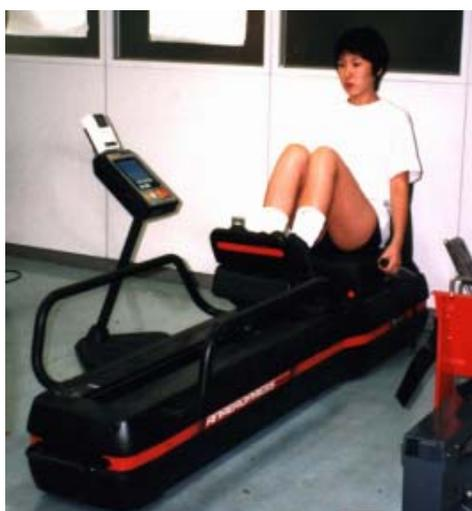
写真 2 無酸素性パワー測定装置(脚伸展パワー)
