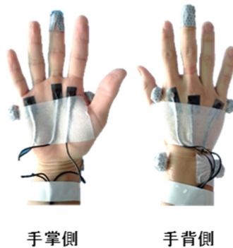
Fig. 1 反射マーカ―と圧力センサを貼付した手部
