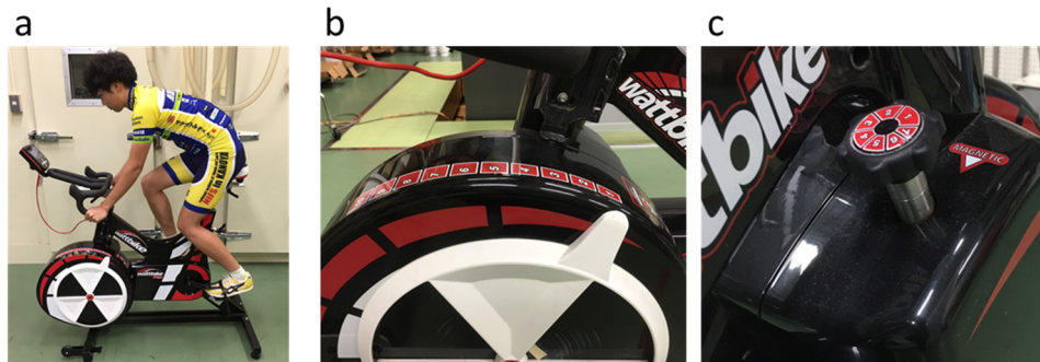
図 1. a は Wattbike の全体像, b は空気抵抗調整レバー, c は磁石抵抗調整つまみ
