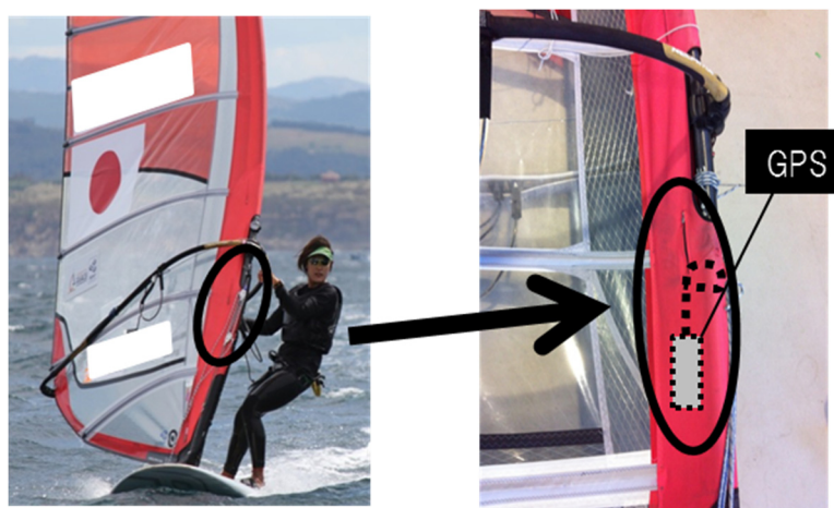
図2. GPSの搭載場所(セールスリーブの内側)
