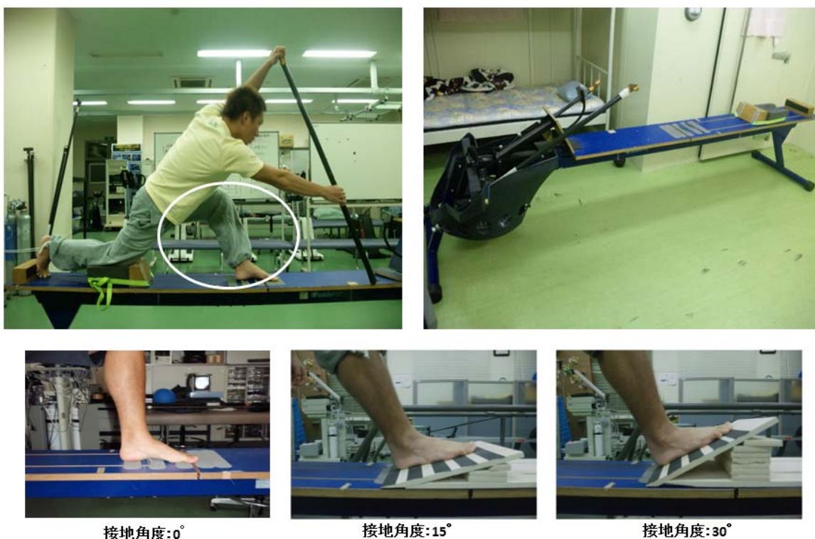
図 1. 実験に用いたカヌーエルゴメータ(上)と, 3 種類の前足の接地角度条件(下)
